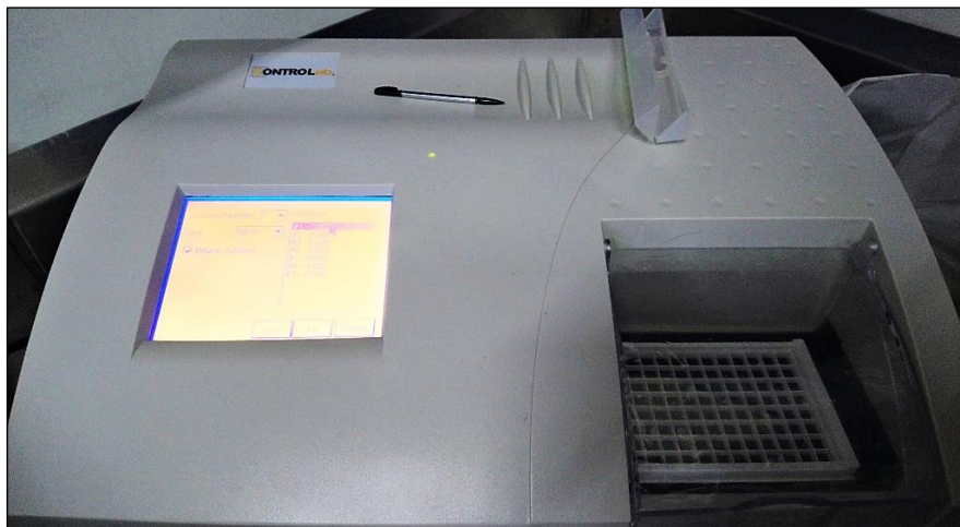
Figura 12. Espectrofotómetro Eli Read RT-2100C para determinación de ferritina por ELISA (KONTROLab ®, 2002).
