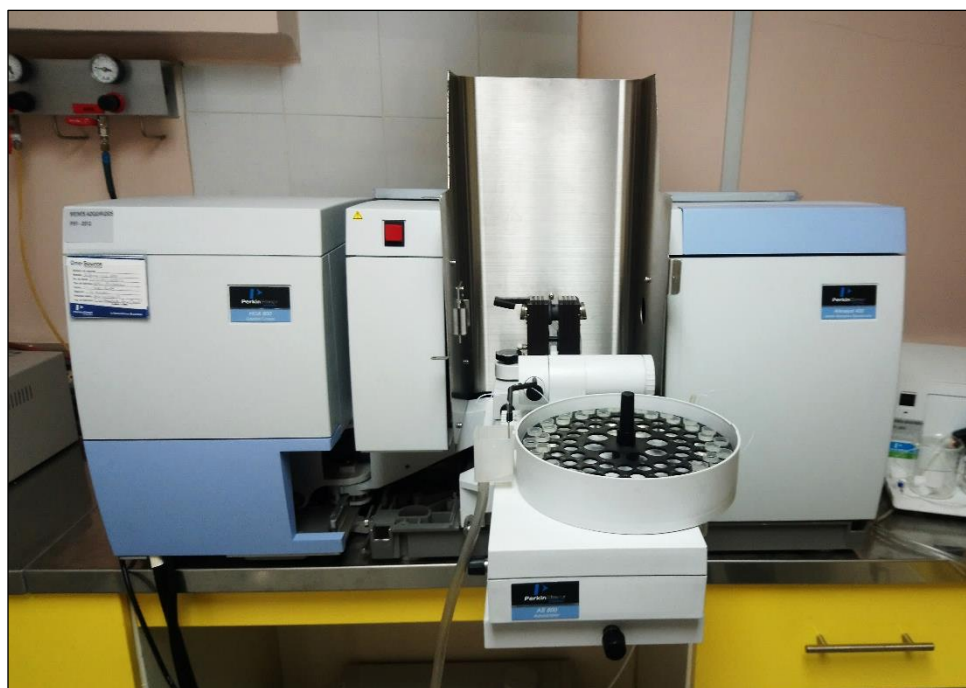
Figura 9. Espectrofotómetro de absorción atómica Perkin Elmer, modelo AAnalyst 400, con horno de grafito H6-900 (Perkin Elmer, 2012).
