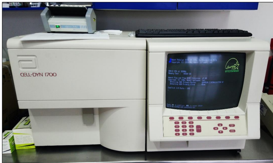
Figura 13. Analizador hematológico Cell Dyn 1700 de Abbott Diagnostics para la realización de citometría hemática (Abbott Diagnostics, 1995).
