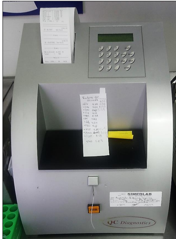
Figura 11. Fotómetro de química clínica QC Diagnostics, para la determinación de la capacidad total de fijación de hierro (SEAC, 1999).
