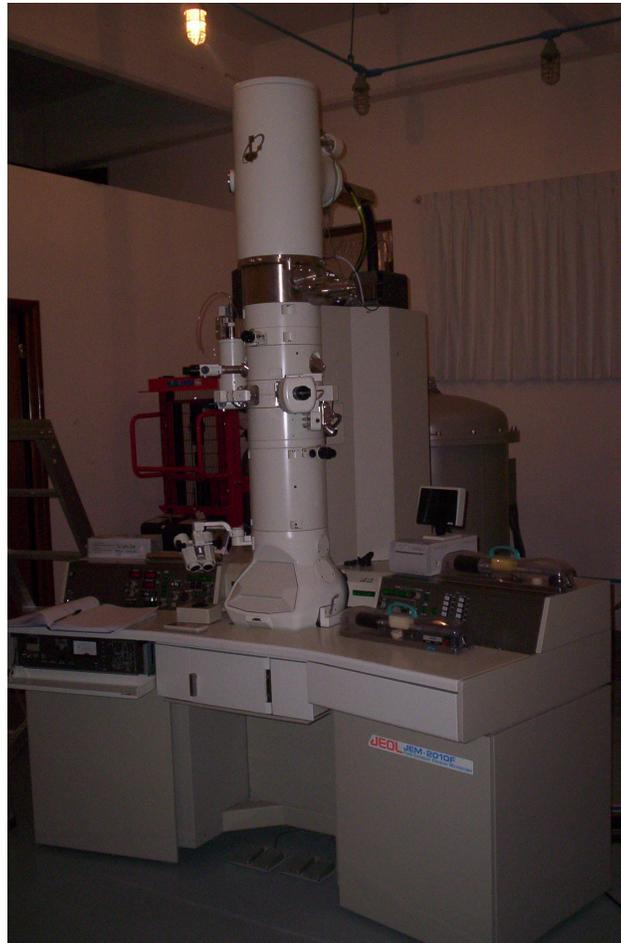
Figura 14.- Arreglo experimental del equipo de criofractura y del microscopio electrónico de transmisión utilizado.
