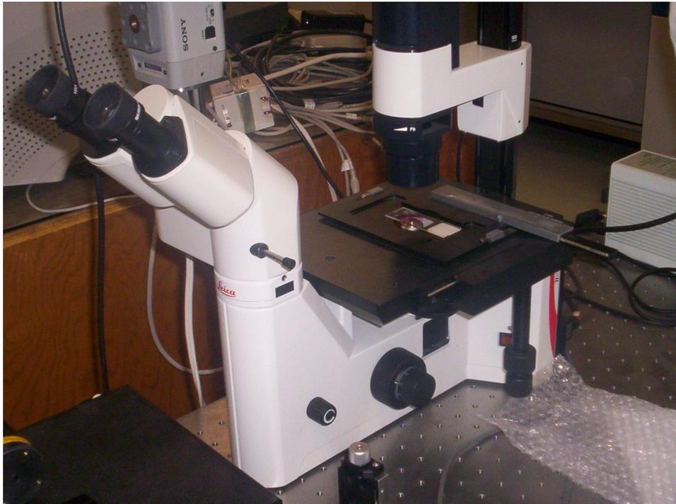
Figura 11.- Arreglo experimental del microscopio óptico utilizado en el Laboratorio de Biofísica de la Universidad de Sonora utilizado para observar los liposomas obtenidos de las mezclas de fosfolípidos.
