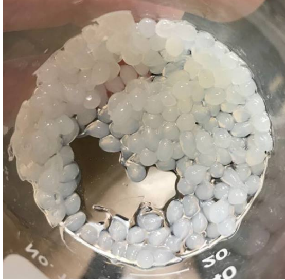
Ilustración 15. Perlas del biocomposito de quitosano-alginato, obtenido mediante precipitación con tripolifosfato.
