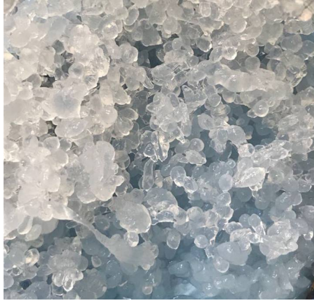
Ilustración 14. Perlas de alginato sintetizadas utilizando la técnica reportada por Sillerová et al. 2015.
