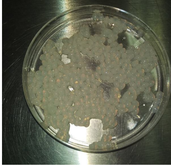
Ilustración 13. Perlas de quitosano de medio peso molecular, sintetizadas utilizando la técnica reportada por Wang et al. (2001), con modificaciones.
