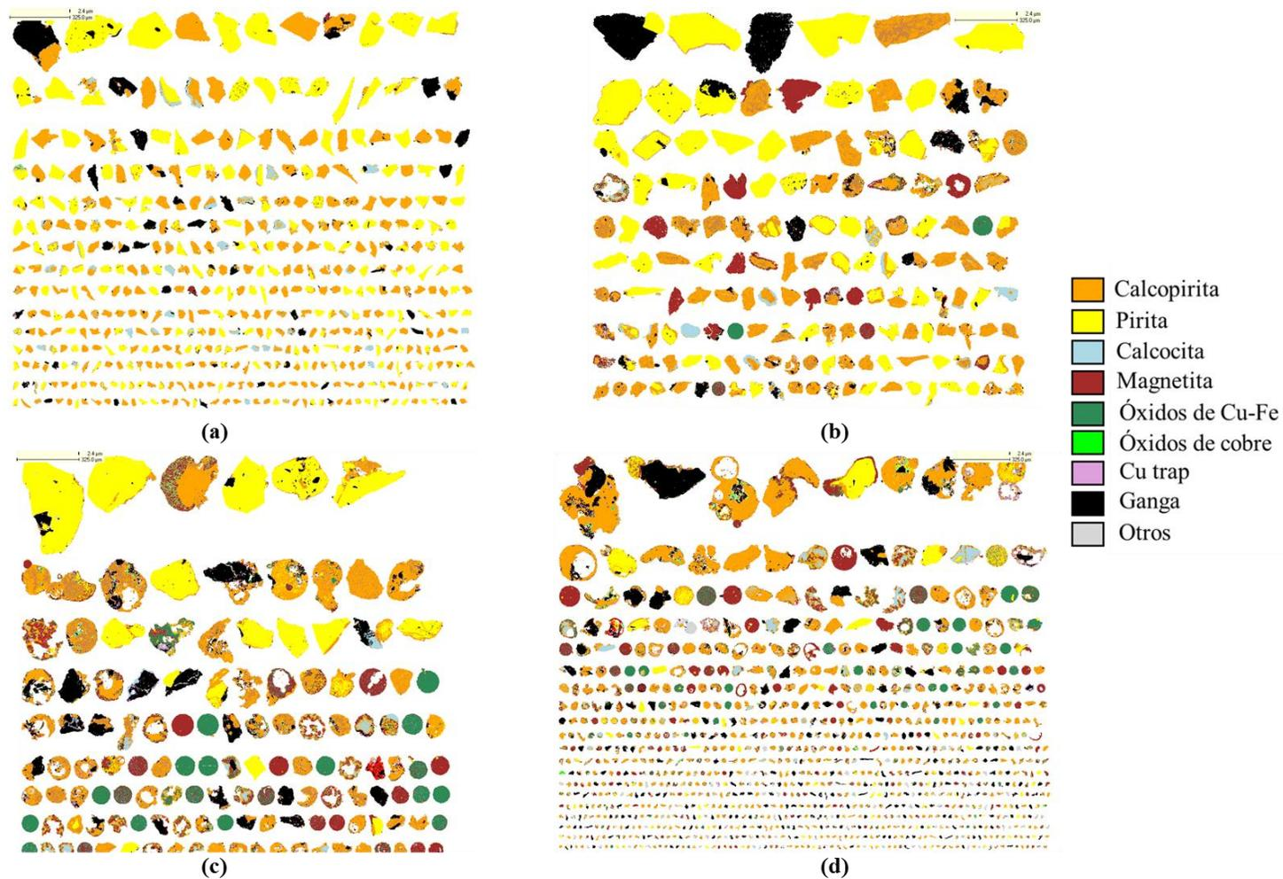
Figura 4.30.- Imágenes de falso color de las muestras oxidadas y del material alimentado sin cribar.
