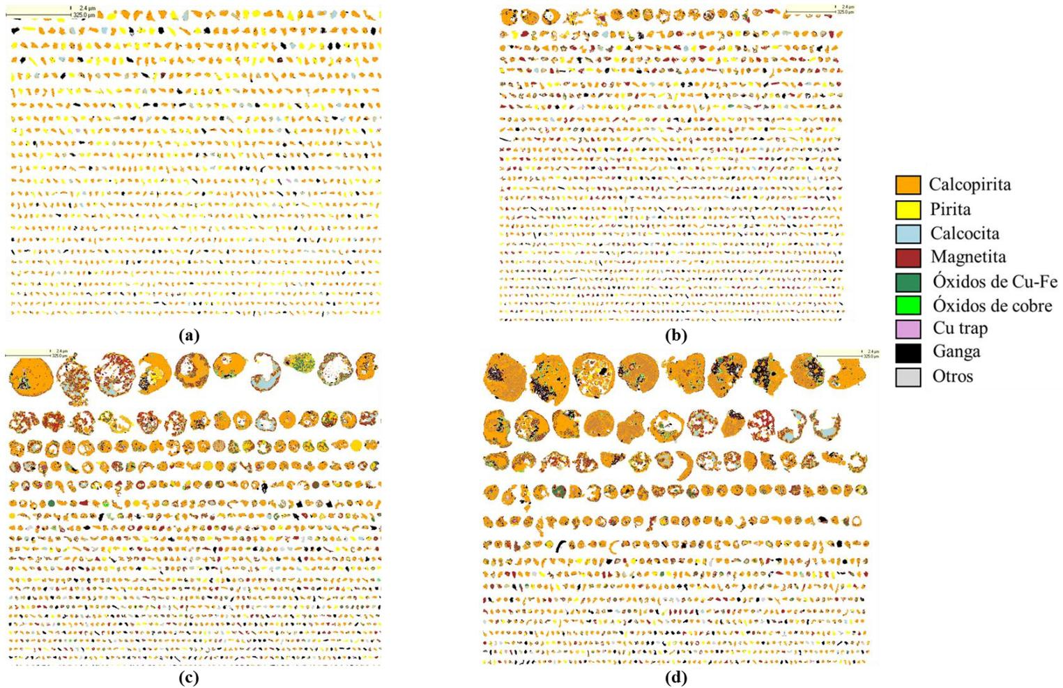
Figura 4.27.- Imágenes de falso color de las muestras oxidadas de la fracción  $<45 \mu\text{m}$  y del material alimentado.
