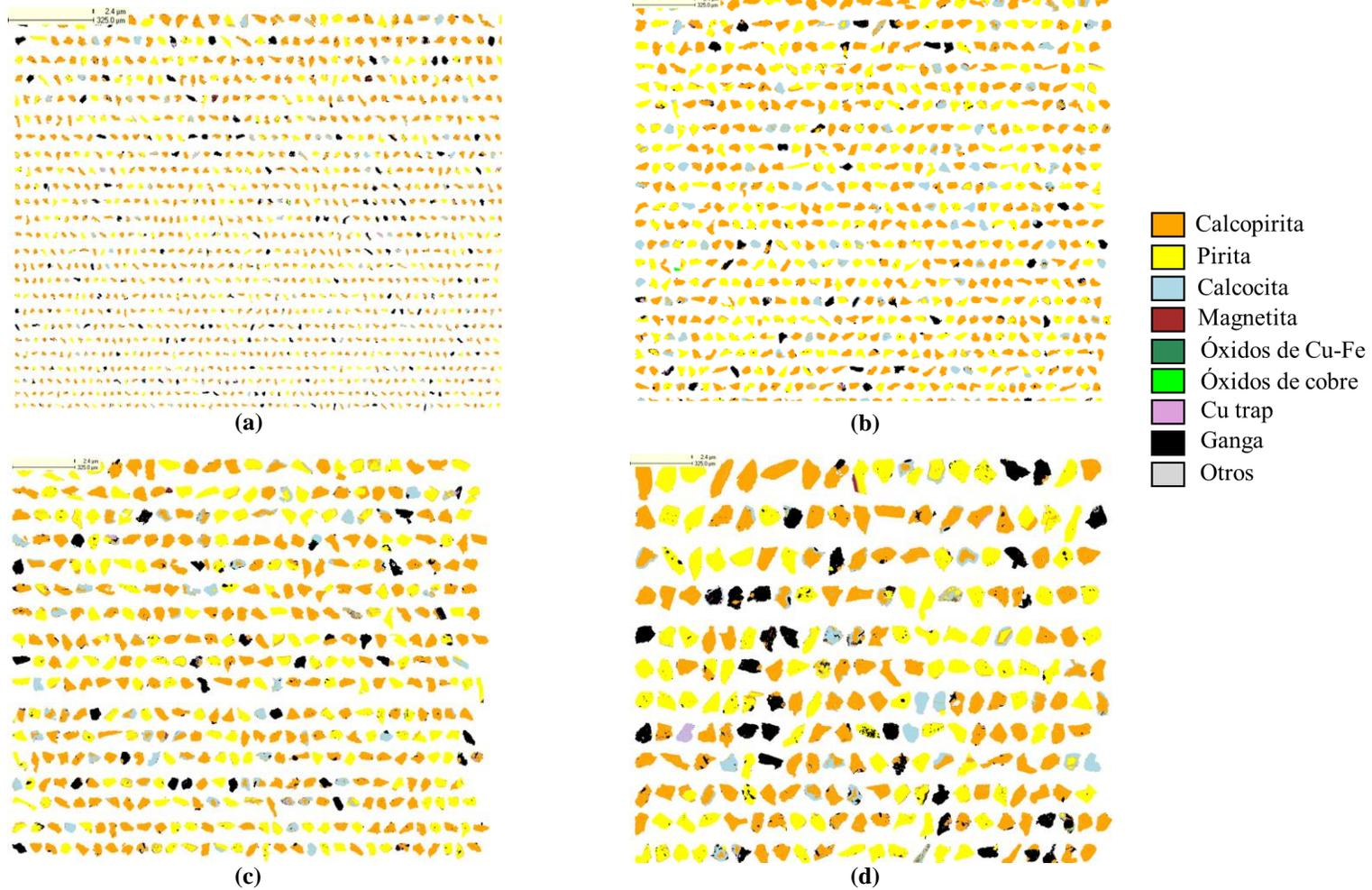
Figura 4.24.- Imágenes de falso color de las fracciones (a)  $< 45 \mu\text{m}$ , (b) 45-53  $\mu\text{m}$ , (c) 53-74  $\mu\text{m}$  y (d) 74-106  $\mu\text{m}$  en la alimentación. La lista de colores indica la especie mineralógica presente en la muestra.
