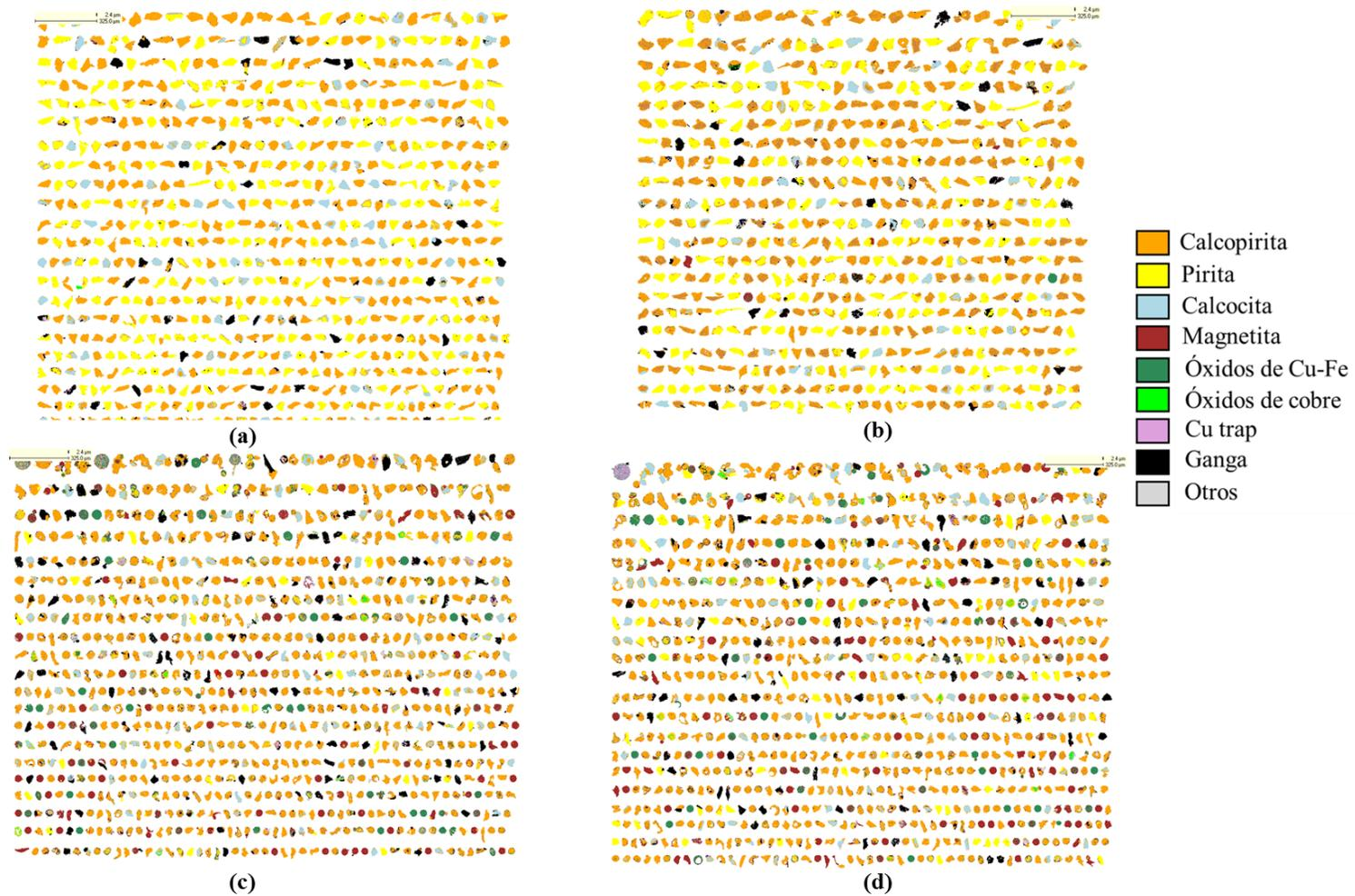
Figura 4.28.- Imágenes de falso color de las muestras oxidadas de la fracción 45-53  $\mu$ m y del material alimentado.
