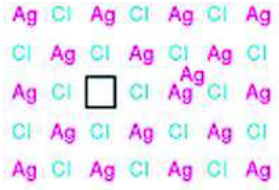
Figura 4. Representación de defectos de Frenkel.
