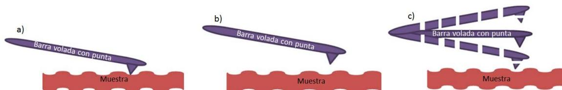
*Figura 12 Modos de operación AFM a) modo de contacto, b) modo de no contacto y c) modo oscilador [28].*
