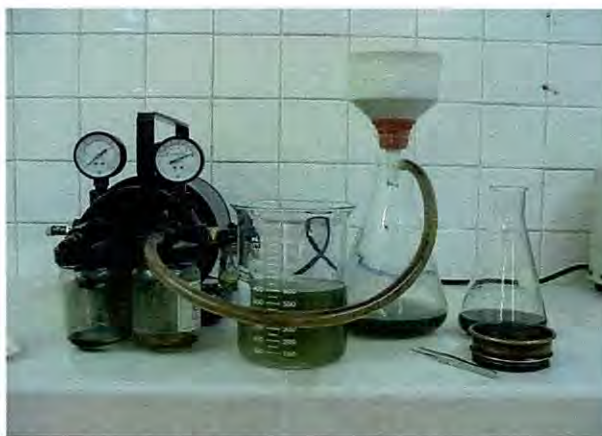
Fig. 5.- Obtención del filtrado de Trichoderma mediante la técnica de Siddiqui, et. al. (2001):
