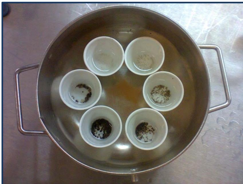
**Figura 29.** Determinación de sólidos suspendidos volátiles.
