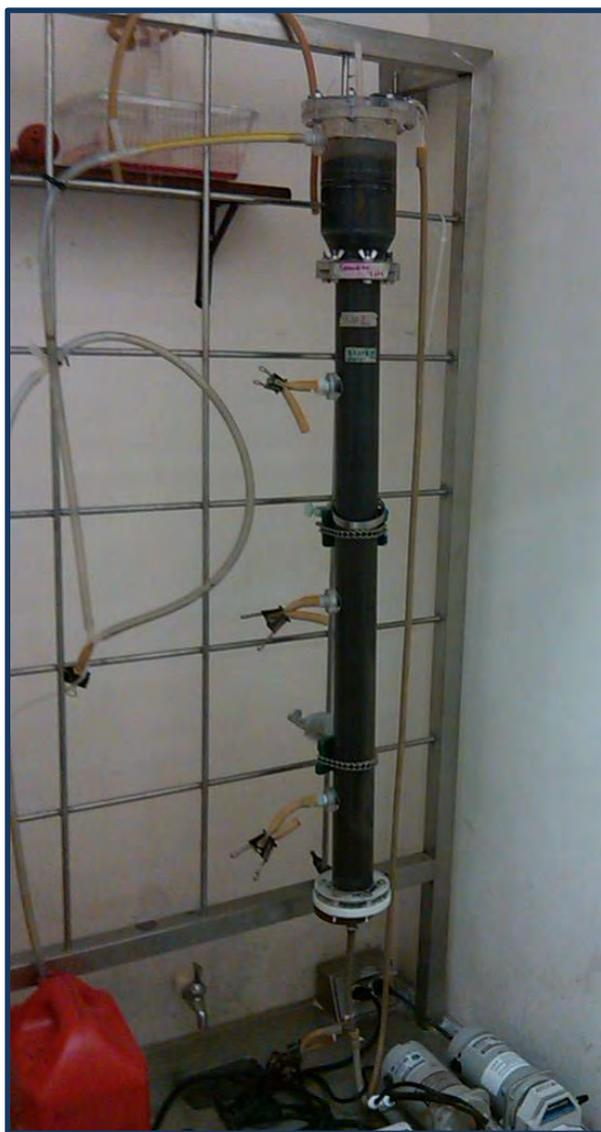
**Figura 30.** Reactor EGSB utilizado para las pruebas en continuo.
