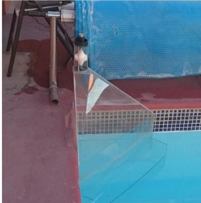
**Figura 11. OWC con ducto de forma U.**
