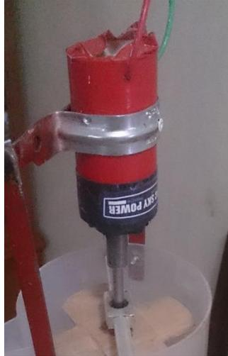
**Figura 21. Generador de 12V.**
