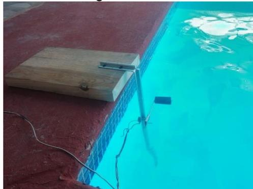
**Figura 5. Medidor de Olas.**
