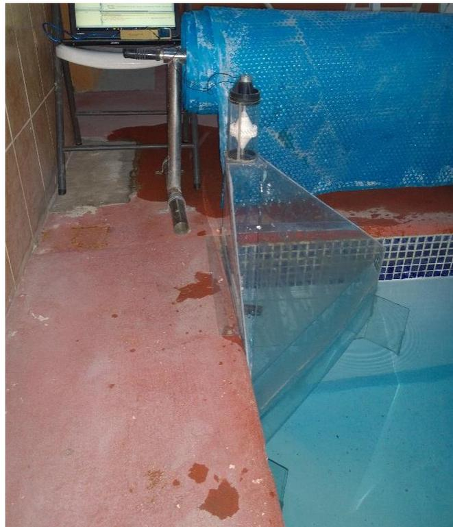
**Figura 12. OWC con extensión en la pared frontal.**
