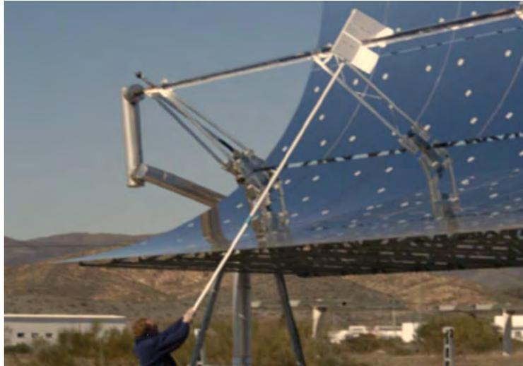
**Figura 4.** Objetivo plano difuso perpendicular a la dirección del receptor cilindro parabólico, Lüpfer et al. [18]
