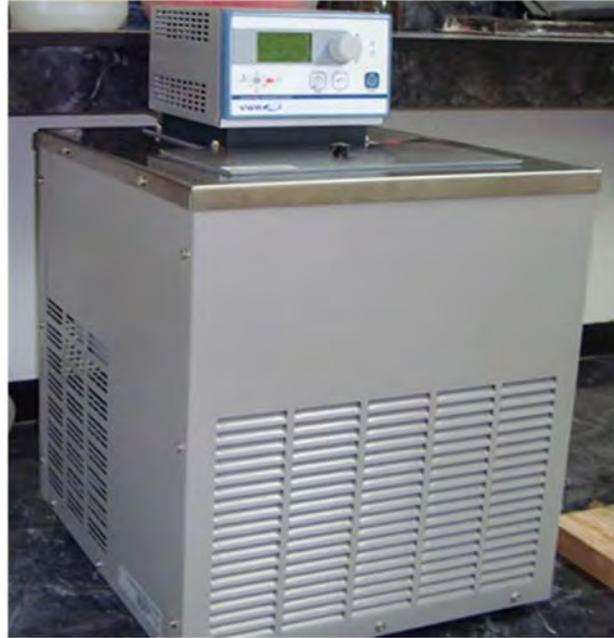
Figura 3.7 Sistema de baño termostático.
