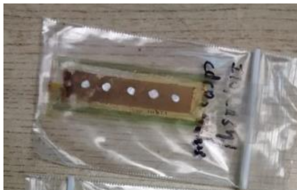
Figura 5.10 Unión p-n de CdS/CdSe donde el CdSe se produjo modificando la película de CdCO 3 .
