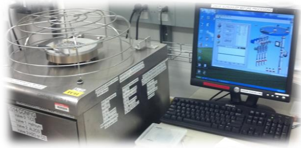
Fig 20. Equipo de depósito por capa atómica (a la izquierda) y el software para controlar los precursores y la temperatura de depósito (derecha).
