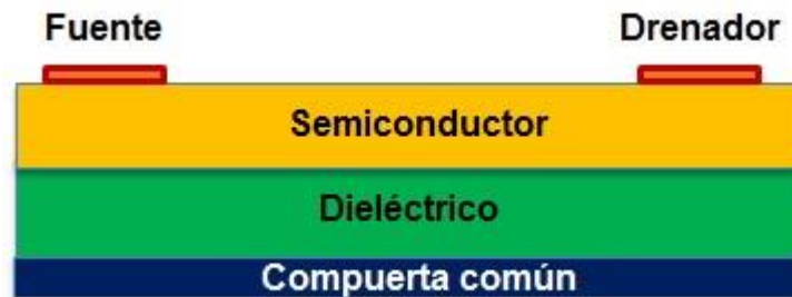
Fig 21. Estructura de un transistor tipo escalonado con compuerta inferior.
