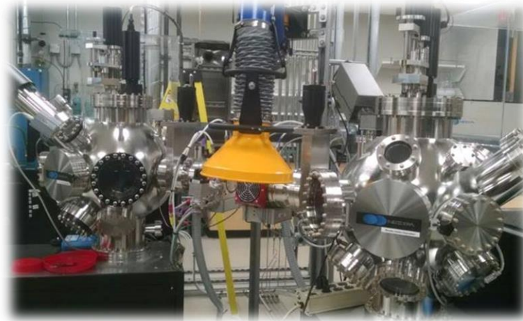
Fig 22 Equipo de depósito por láser pul sado. En la imagen se aprecia la cámara de propósito general (izquierda), de óxidos (derecha) y el extractor (en medio).
