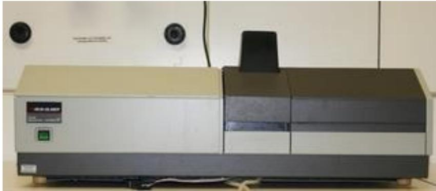
Figura 11. Espectrómetro UV-vis de la marca Perkin Elmer, modelo Lambda 9.
