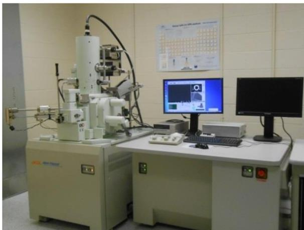
Figura 9. Microscopio electrónico de barrido de emisión de campo (MEBEC) de la marca comercial JEOL modelo 7600F.
