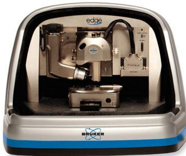
Figura 20. Equipo de AFM de Bruker utilizado.
