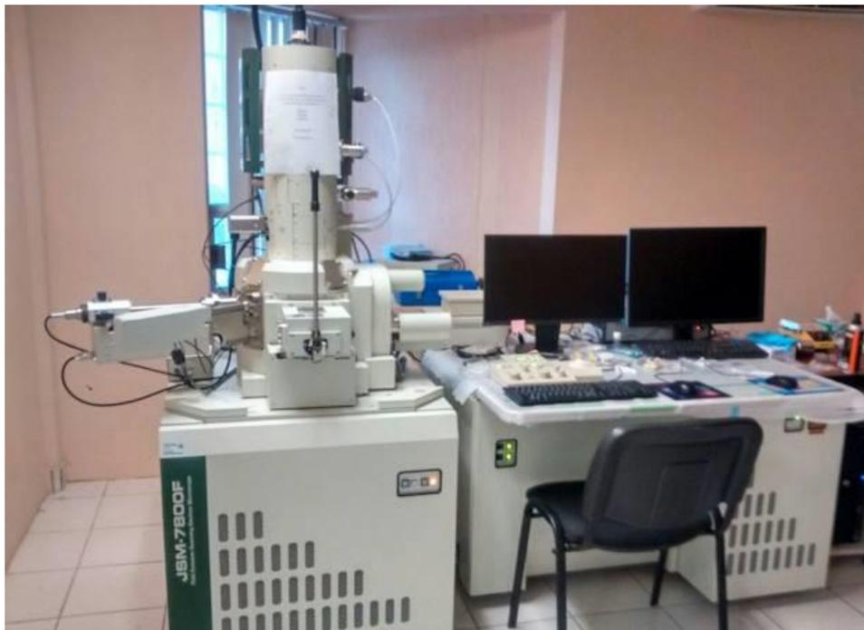
Figura 23. Microscopio electrónico de barrido JEOL JSM-7800F usado en los experimentos.
