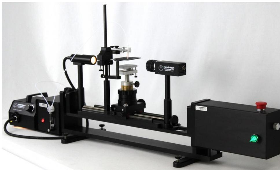
Figura 24. Esquema del goniómetro Ramé Hart 590 usado para medir el ángulo de contacto.
