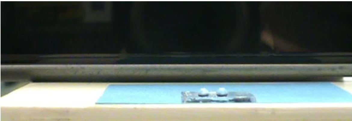
Figura 72. Gota de agua en una superficie de PDMS/SiO<sub>2</sub> (0.04 mM).
