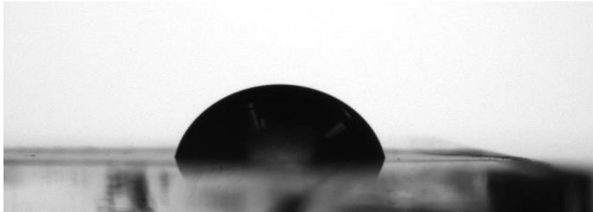
Figura 59. Gota de agua sobre una superficie de PS/PMMA 40/60 sin PDMS.
