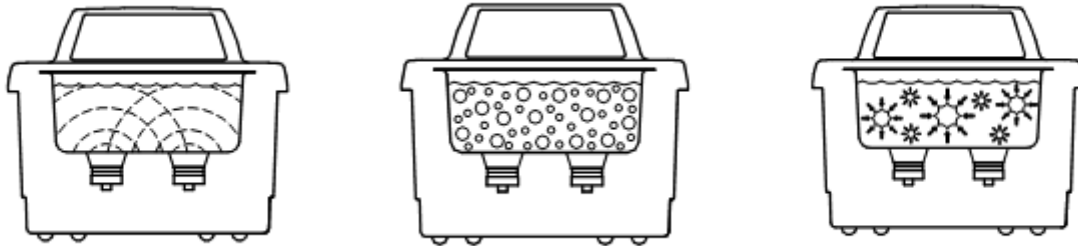
Figura 3. Esquema del proceso de sonicación en el ultrasonido[26].
