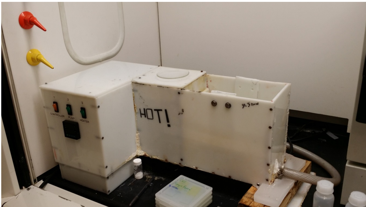
Figura 3.1: Equipo de CBD utilizado para este trabajo.
