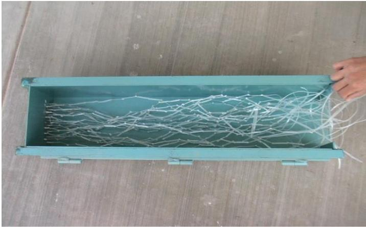
**Figura 1. Molde engrasado con fibra de PET en una cara.**
