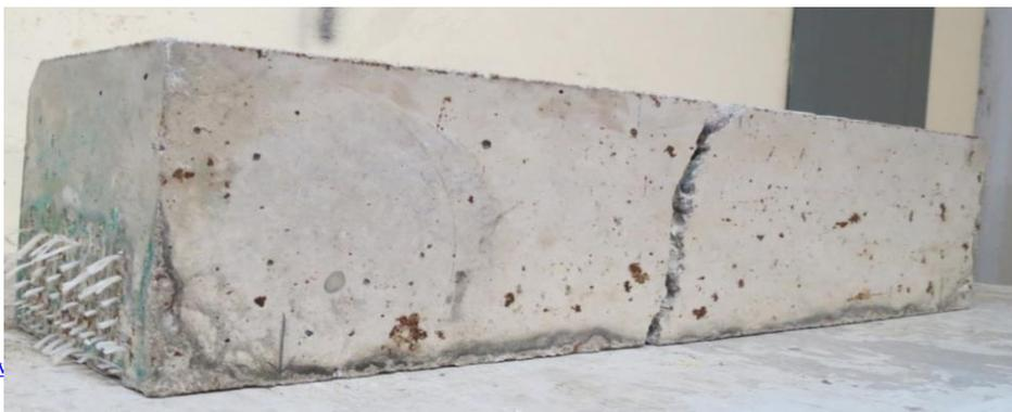
**Figura 13. Falla a flexión de la viga sin nodos, parte 1.**
