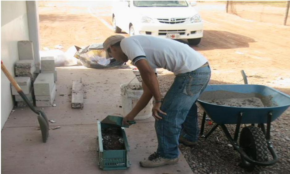
**Figura 5. Colocación de la mezcla de concreto en el molde de acero en tres capas, con su respectiva compactación.**
