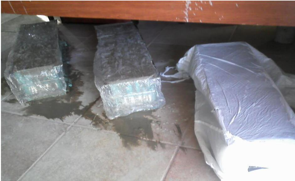
**Figura 7. Curado de los especímenes de concreto para evitar la evaporación del sangrado.**
