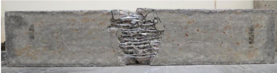
**Figura 11.1. Falla a flexión de la viga con nodos, parte 2.**
