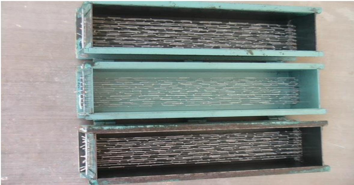
**Figura 2. Pre-tensando de las fibras de PET con nodos.**
