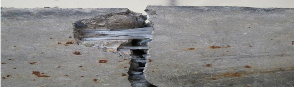
**Figura 14. Falla a flexión de la viga sin nodos, parte 2.**
