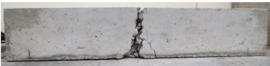
**Figura 11. Falla a flexión de la viga con nodos, parte 1.**
