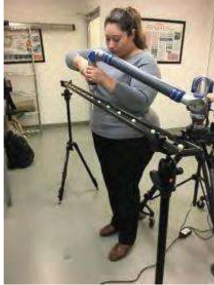
Figura 4.3. Captura de puntos en esferas de la barra patrón.
