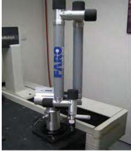
Figura 2.1 Brazo articulado de medición por coordenadas (BAMC). Universidad de Sonora.
