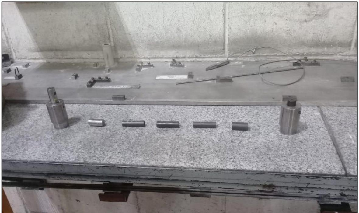
**Figura 4.3.** Guías para enderezado de alambre.
