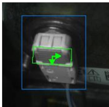
**Figura 4-23** Conector con región de búsqueda, patrón y orientación indicadas
