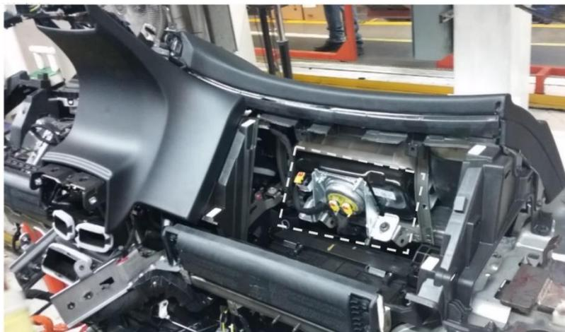
**Figura 4-7** Vista general del panel de instrumentos (el área a inspeccionar se muestra en blanco)
