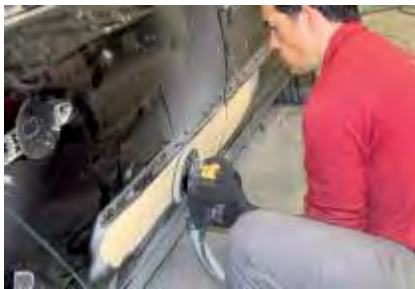
Figura 4.50 Usar guantes al utilizar herramientas eléctricas reduce la transmisión de vibraciones.
