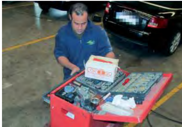
Figura 4.47 Los carros de herramientas permiten tener al alcance las herramientas y seleccionar la más adecuada a cada tarea.
