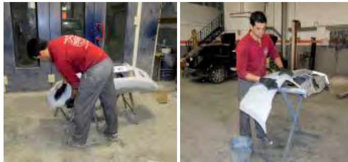
Figura 4.56 Regular la superficie de trabajo para conseguir la altura correcta.
