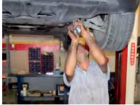
Figura 4.45 Presión de la herramienta sobre las partes blandas de la mano.
