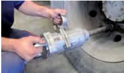
Figura 4.49 Herramientas pesadas con elevada vibración.
