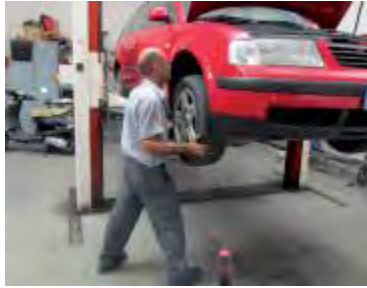
Figura 4.36 Ajuste de la altura del automóvil para un correcto manejo de las cargas.
