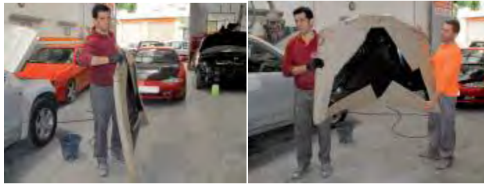
Figura 4.33 Manipulación manual de cargas dificultosas entre dos personas.
