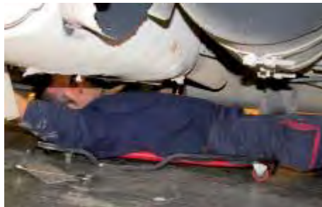
Figura 4.16 Plataforma con ruedas para facilitar el trabajo acostado
