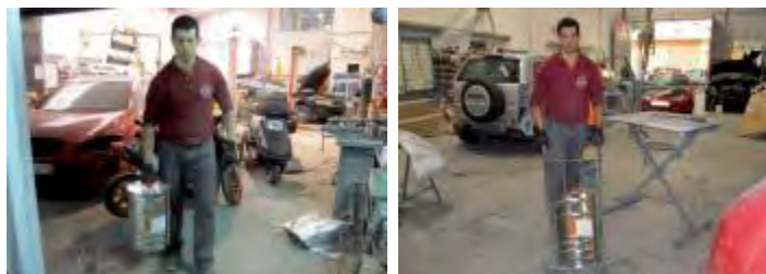
Figura 4.35 Los carros para bidones facilitan el manipulado y transporte.
