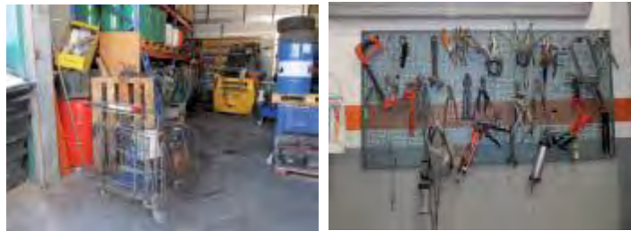
Figura 4.60 Falta de orden en las herramientas y zonas de almacenaje.
