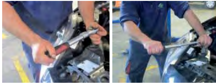
Figura 4.43 Herramientas con el mango más largo o ajustable reducen el riesgo.
