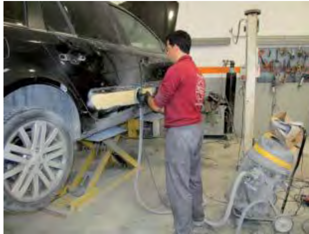
Figura 4.14 Uso de elevador para mantener una postura correcta de brazos, tronco y cuello.
