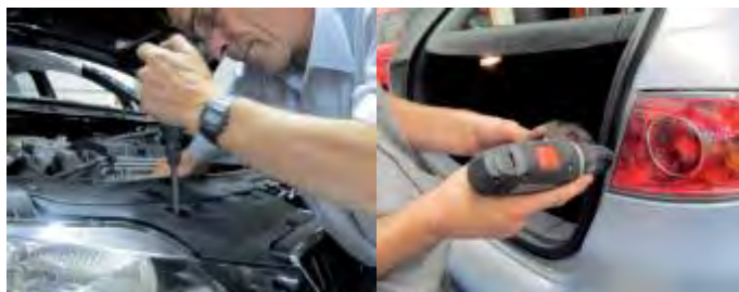
Figura 4.24 Usar herramientas eléctricas para el desmontaje
