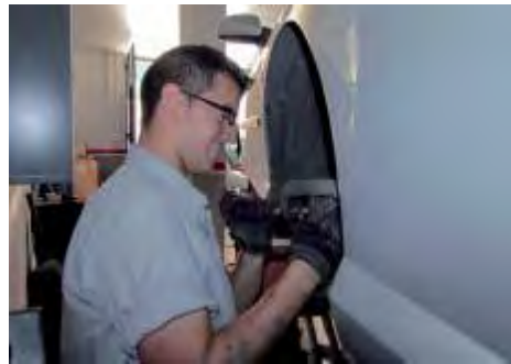
Figura 4.18 Elevar el plano de trabajo para evitar permanecer arrodillado.
