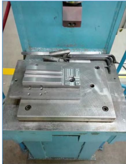
Figura 5.1 Elemento de sujeción para estampado de piezas
