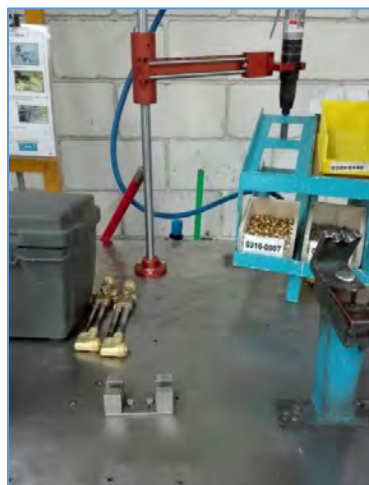
Figura 4.41. Resultado del diseño del elemento de fijación estación 9.
