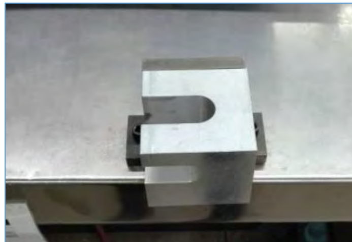
Figura 4.37. Resultado del diseño del sujetador de Cutting attachment Estación 4.
