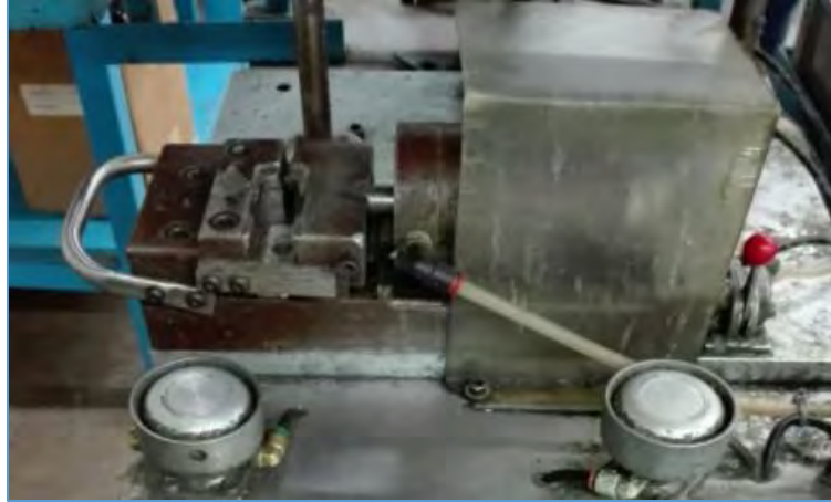
Figura 4.39. Resultado del diseño del elemento de fijación estación 6.
