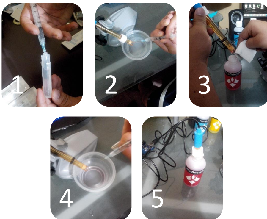
Figura 4.6. Procedimiento de cambio de sustancia
