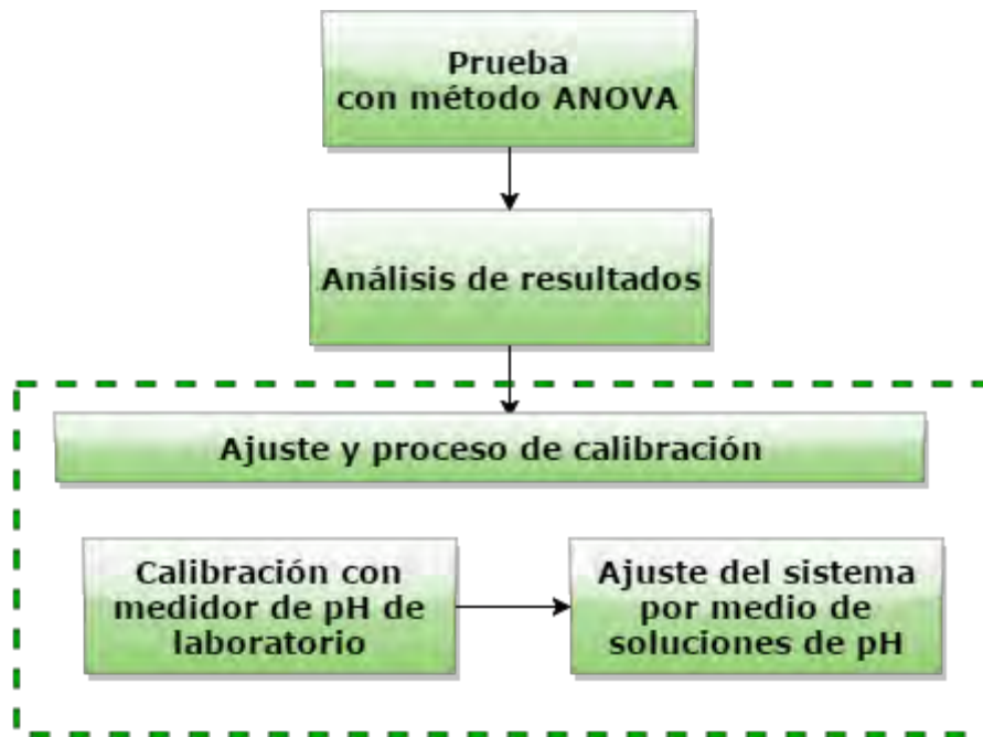
Figura 3.4. Evaluación del sistema de medición (elaboración propia)
