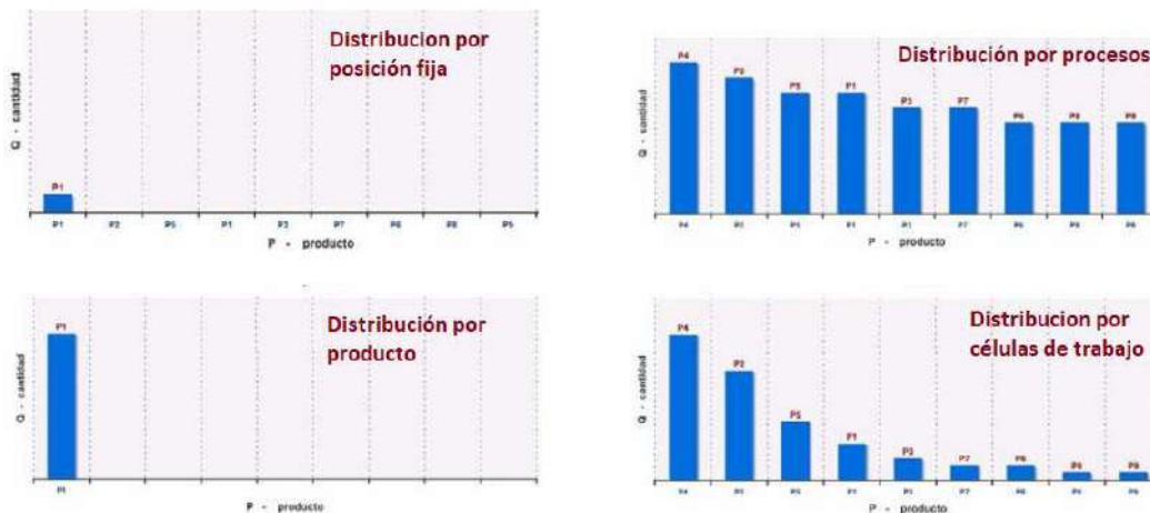
Figura 3.3. Ejemplo de gráficas P-Q según cada tipo de distribución (Gaibort, 2017).
