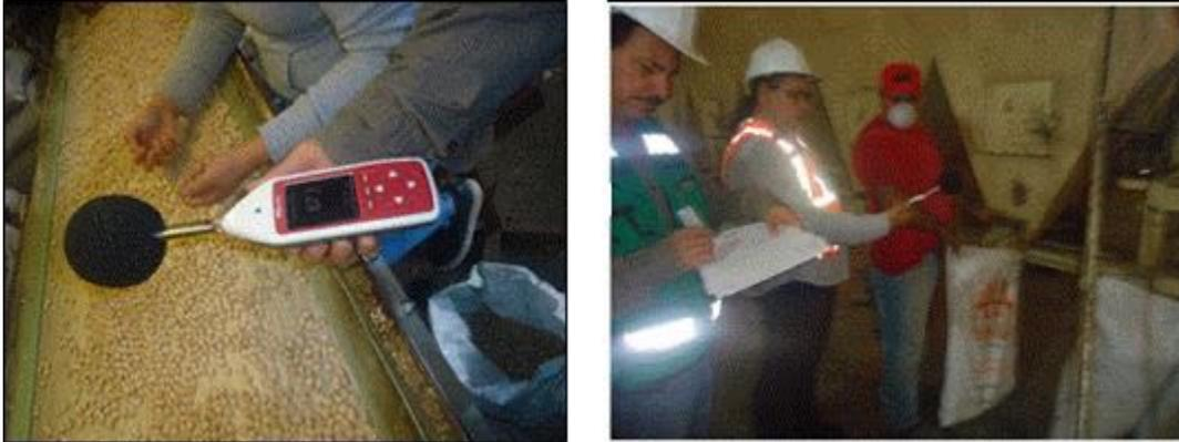
**Figura. 4.16.** Medición del ruido laboral con sonómetro.
