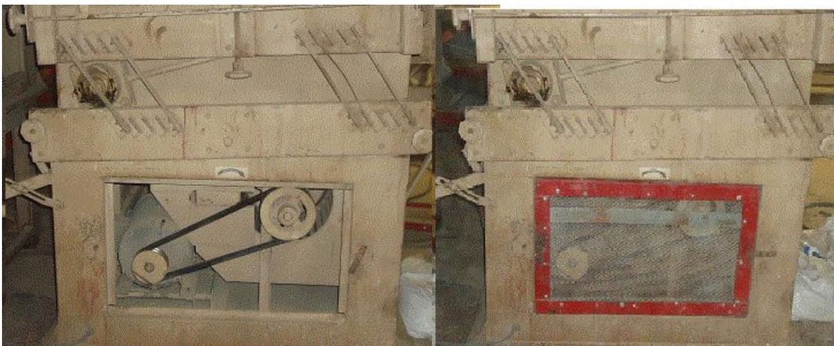
*Figura 4. 11. Antes y después de la colocación del guarda bandas en maquinaria.*
