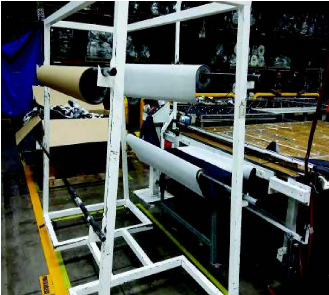
Figura 4.2. Rodillos utilizados como apoyo para el desdoble y corte de los lienzos de vinil en las medidas deseadas.
