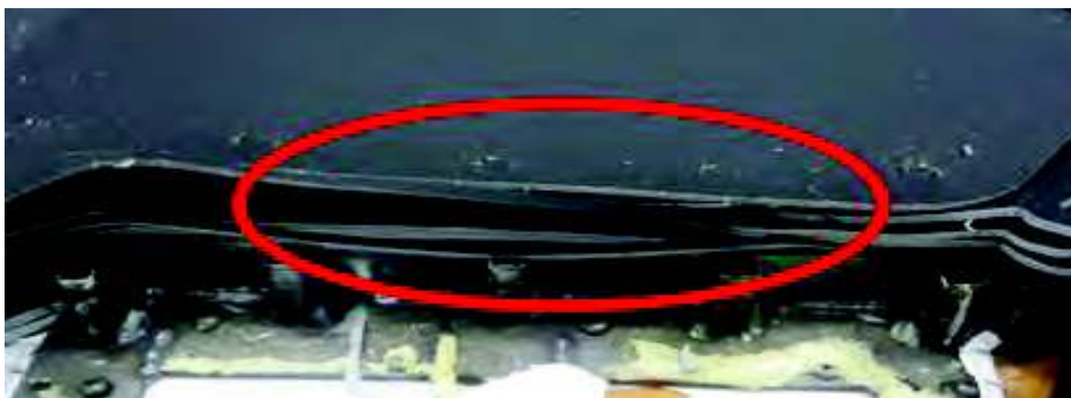
Figura 4.4. Defecto en vinil generado por doble golpe.
