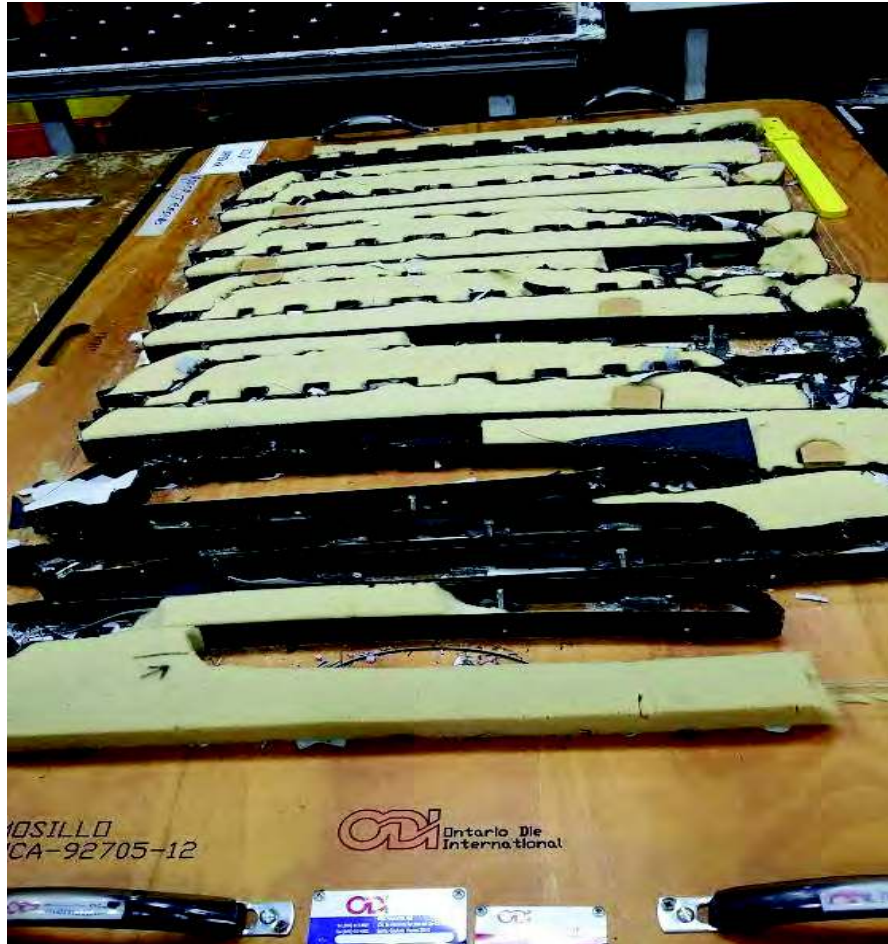
Figura 4.3. Dado de corte utilizado en máquina cortadora
