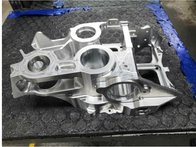
**Figura 7.11.** Pieza de aluminio de 5 ejes.
