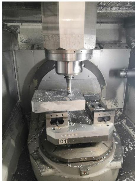
**Figura 7.10.** Interior de una maquina NVM 5000.
