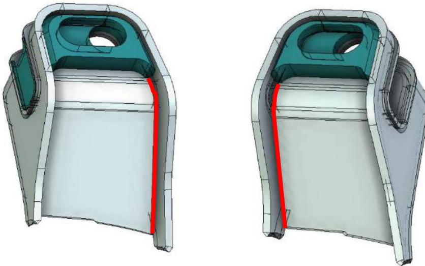
9. Ensambla y suelda TB-031-001-T0015. Asegúrate que el tubo se encuentre concéntrico y colocado de manera correcta.
