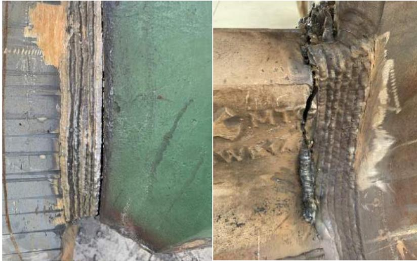
**Figura 4.15** Indicaciones en soldadura localizadas por Ultrasonido
