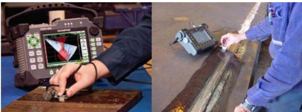
**Figura 2.2** Ejemplos de equipo para UT (Romero y Proboste,2013)
