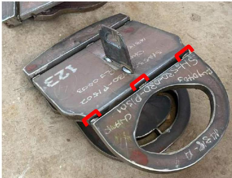
**Figura 4.20** Ejemplo de puntos o cordones de soldadura en armado
