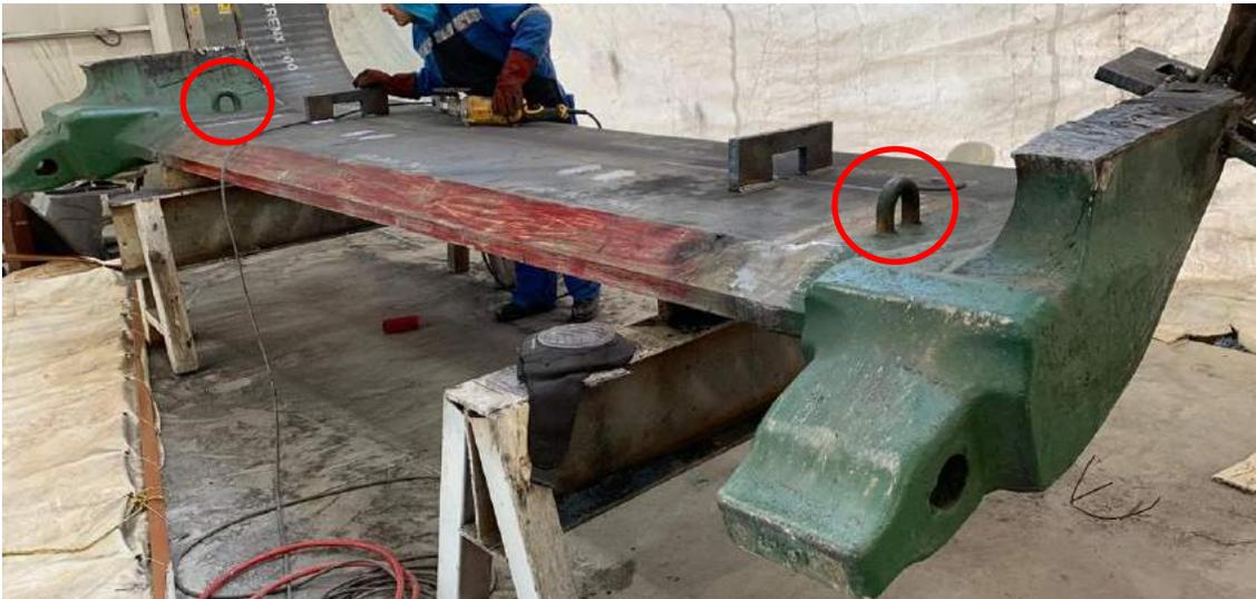
**Figura 4.21** Ejemplo de agarres para movimiento de ensamble
