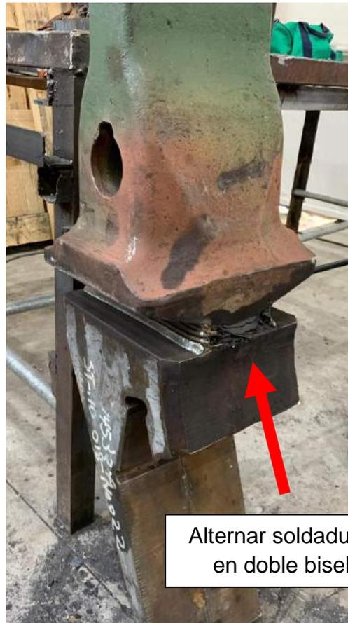
**Figura 4.36** Fotografía de alternado de soldaduras en doble bisel
