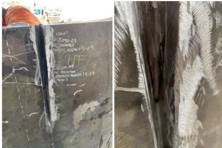
**Figura 4.16** Indicación localizada por prueba no destructiva
