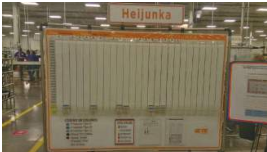
Figura 4.14. Tablero Heijunka del área de Corte.
