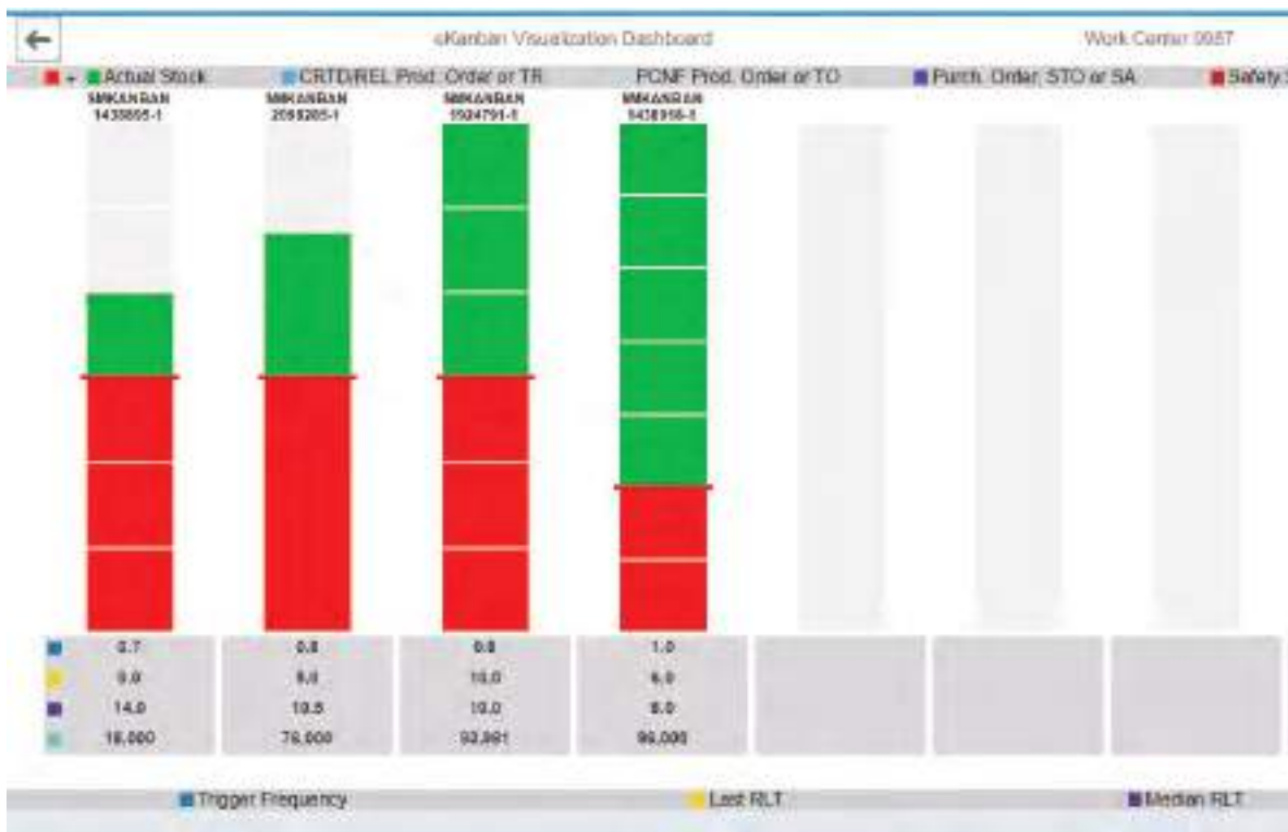
Figura 4.31. Kanban – Monitoreo de Máximos y Mínimos de Inventario.
