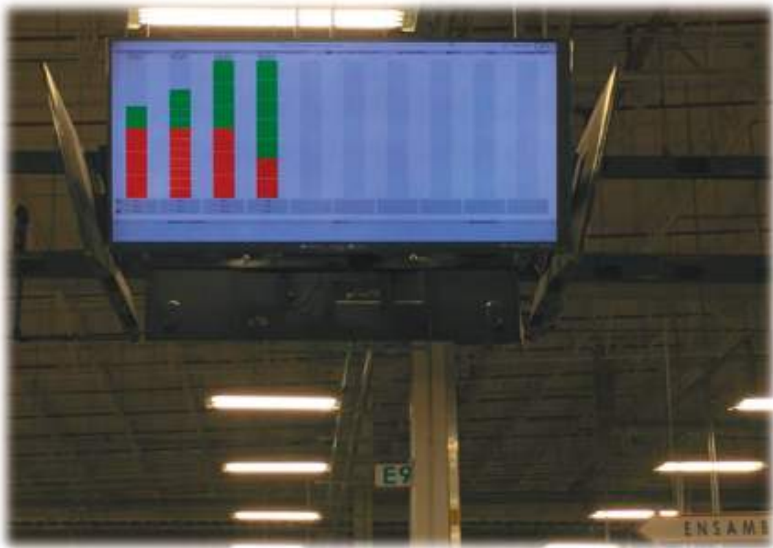
Figura 4.32. Tablero electrónico E-Kanban.
