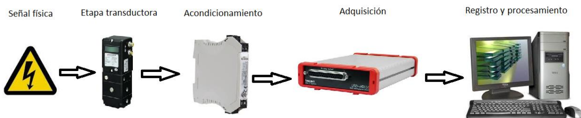
Figura 2.5. Etapas principales de un sistema de adquisición de datos (Estupiñan et al., 2006)
