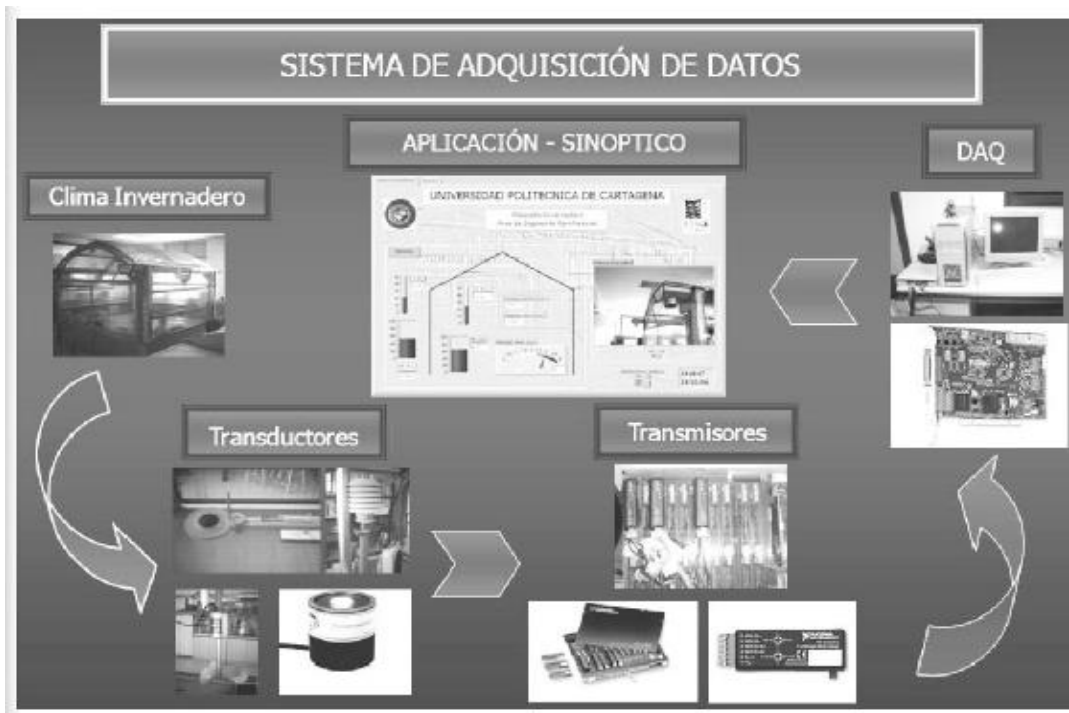
Figura 2.10. Esquema del sistema de adquisición de datos docente (Vázquez, 2010)
