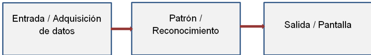
Figura 2.11. Estructura de la interfaz de LabVIEW (Rajesh y Marimuthu, 2011)
