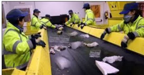
Figura 2.8: Línea de separación de materiales reciclables mezclados.
