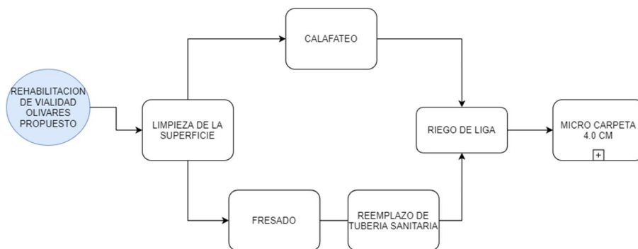
Figura 4.2 Diagrama de flujo proceso constructivo propuesto
