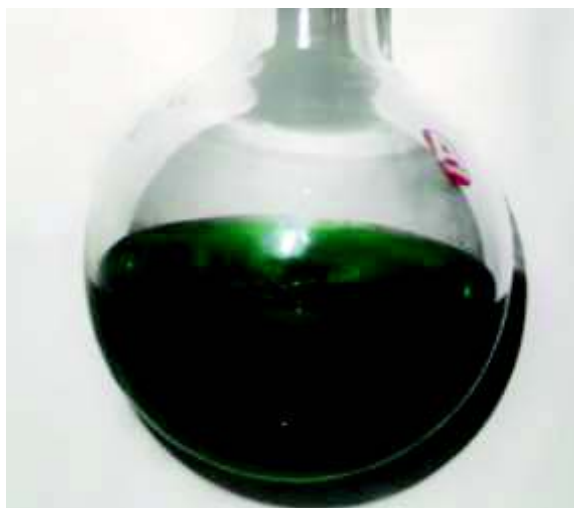
Figura 27. Mezcla de reacción que muestra el color característico de los complejos de cobre(II). Síntesis del complejo L-SCI-SerCu.
