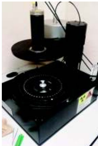
Figura 17. Equipo Risø TL/OSL modelo TL-DA-20 equipado con una fuente de radiación \beta de ^{90}\text{Sr} con un carrusel en su interior.
