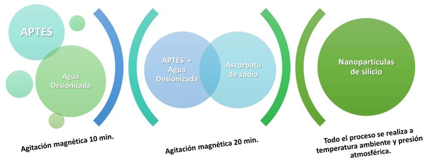
Figura 4.1: Diagrama esquemático del proceso de síntesis de las nanopartículas de Silicio.
