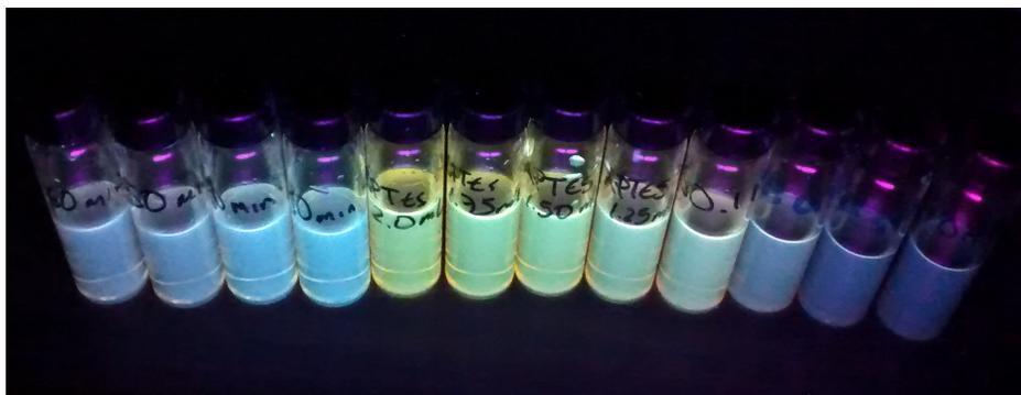
Figura 5.4: Muestras con nanopartículas Silicio de diferente tamaño bajo luz UV.
