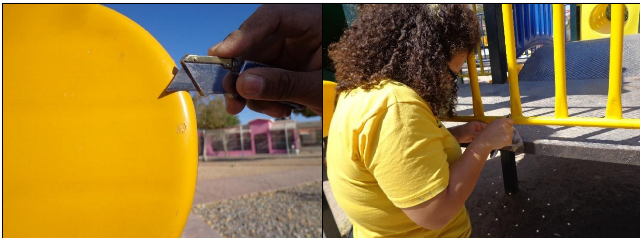
Figura 5. Muestreo de pintura.
