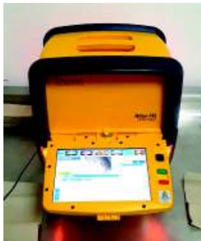
Figura 3. Equipo portátil de fluorescencia de rayos X Niton FXL utilizado para el análisis geoquímico de este trabajo. Este equipo se encuentra en el laboratorio de geoquímica de la Universidad de Sonora
