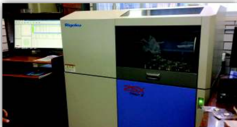
Figura 22. Espectrómetro de fluorescencia de rayos X por dispersión de longitud de onda modelo ZSX primus II de la marca Rigaku con tubo de Rh.
