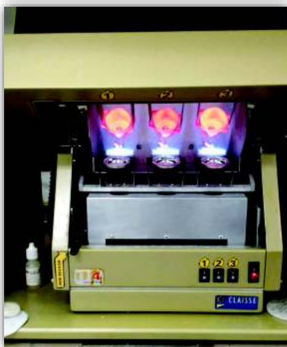
Figura 15. Hornillo de fusión y mezcla fundida en crisoles de Pt y Au. Con 11 minutos en fundición y 4 de ventilación. Se usaron los programas 4 y 7 de este equipo.
