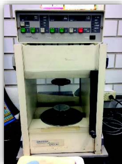
Figura 18. Prensa GRASEBY SPECAC 275 utilizada en la elaboración de tabletas para elementos traza.
