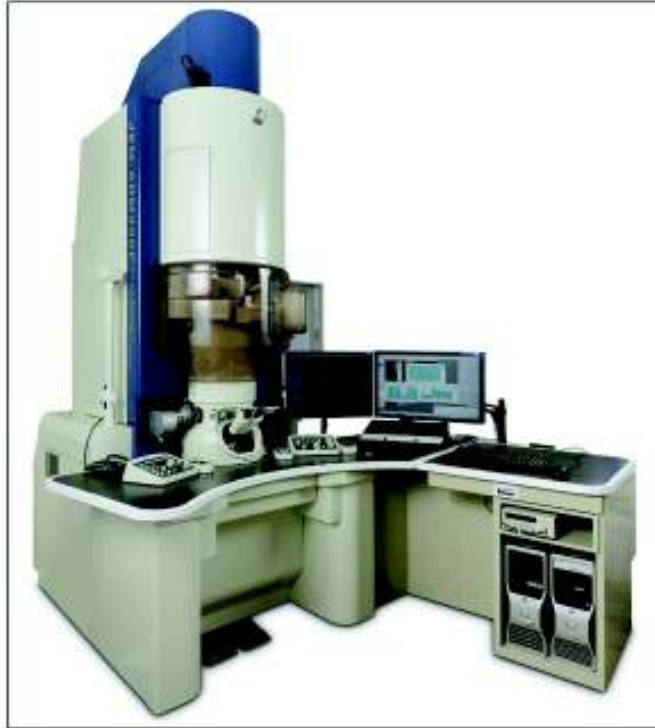
Figura 3.8. Microscopio electrónico de transmisión JEOL JEM-ARM 200F.
