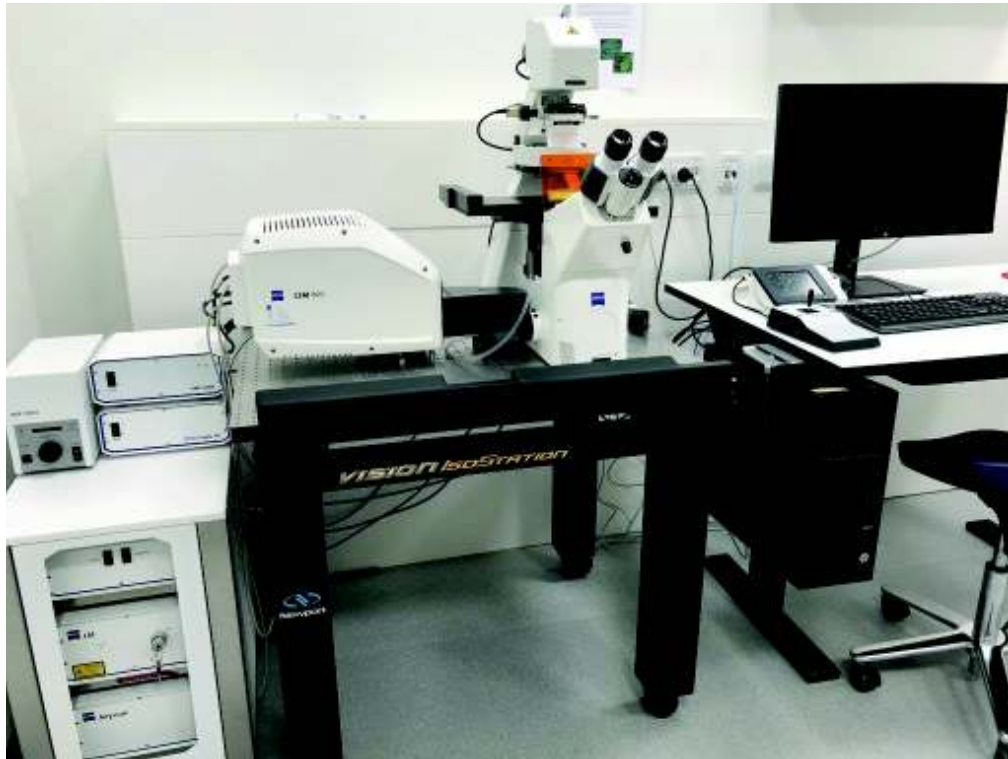
Figura 3.12. Equipo confocal de barrido laser LSM800 (Zeiss).
