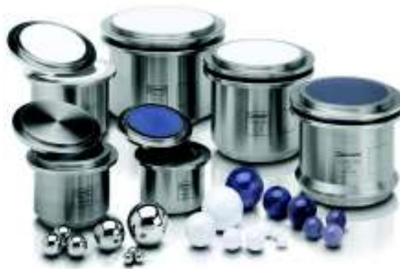
Fig. 11. Vasos de molienda. Molinos de bolas planetarios usados para la síntesis de nanomateriales
