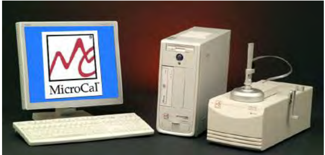
Figura 16. Calorímetro de Titulación Isotérmica VP-ITC, Microcal, Inc.
