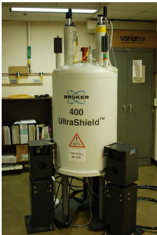
Figura 18. Espectrómetro de Resonancia Magnética Nuclear modelo Bruker AVANCE 400.
