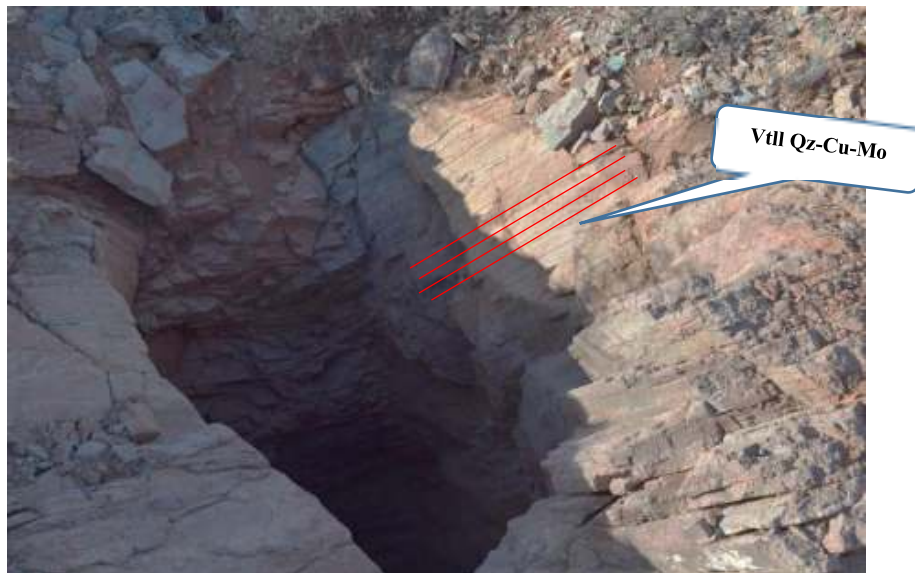
Foto 4. Fotografía de obra minera, la roca corresponde a la roca de caja cuarzomonzonita de grano medio, y se logra apreciar una serie de vetillas sub-paralelas en forma de enjambre. Vtl: Vetilla, Qz: Cuarzo, Cu: Cobre, Mo: Molibdenita.
