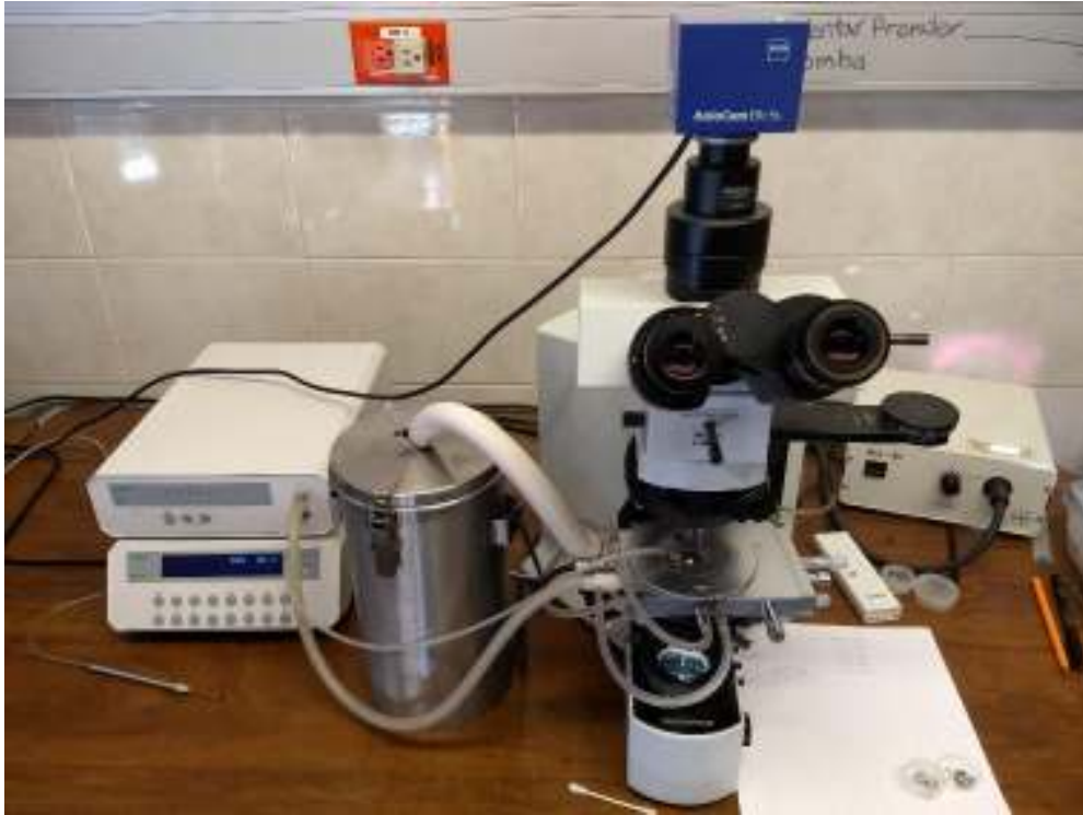
Figura 11. Equipo de laboratorio para inclusiones fluidas, microscopio Olympus, con equipo de micro termometría LINKAM, ubicado en el Laboratorio de microtermometría de la UNAM campus Juriquilla.
