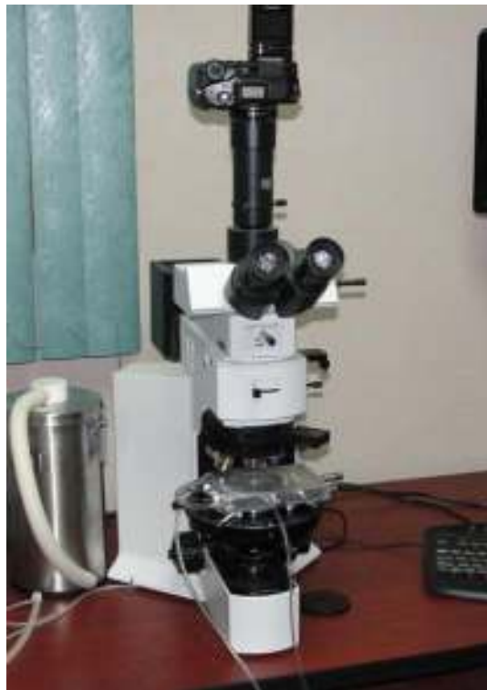
Foto 10. Mostrando microscopio petrográfico marca Olympus, donde se realizaron los estudios con luz transmitida y reflejada, ubicado en el Departamento de Geología de la Universidad de Sonora.
