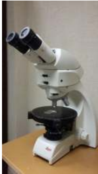
Figura 2. Microscopio vertical de polarización LEICA DM750 P del Departamento de Geología, Universidad de Sonora.
