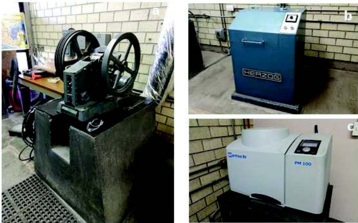
Figura 5. Equipo de preparación de muestras a. Quebradora de quijadas. b. Pulverizadora con contenedor de cerámica. c. Pulverizadora con bolas de ágata.
