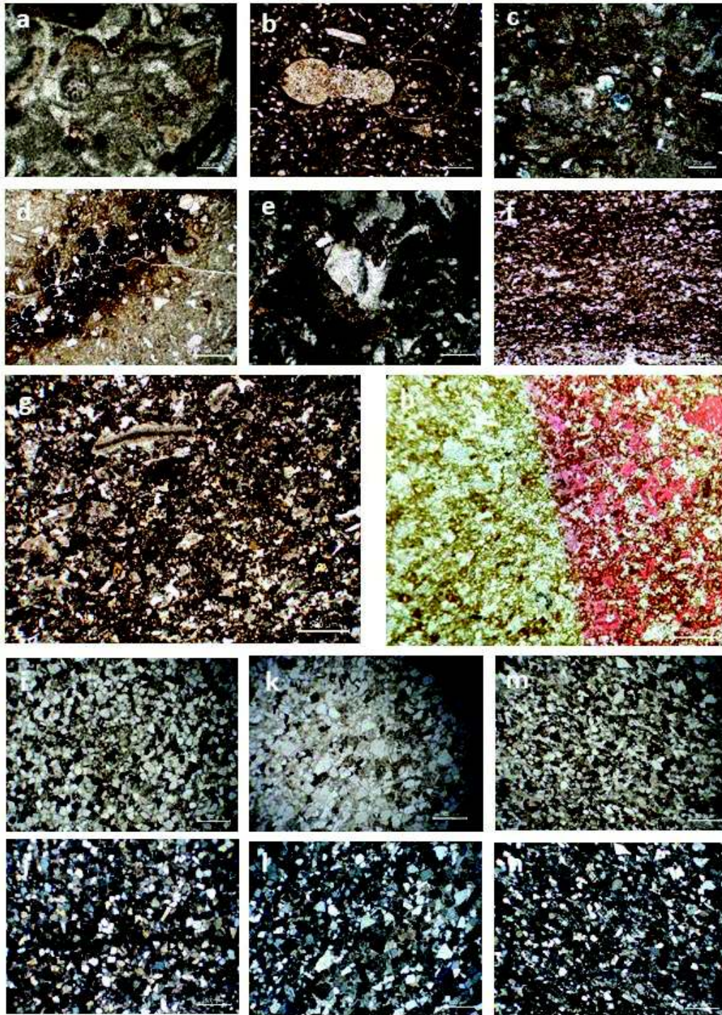
Figura 9. Fotomicrografías de las muestras colectadas en la cañada Los Tubos. a. Alga y microesparita, muestra MU-36, luz natural, lente 10x. b. Amonita, muestra MU-21, luz natural, lente 4x. c. Silicificación muestra MU-23, nicoles cruzados, lente 4x. d. Pirita muestra MU-30, luz natural, lente 4x. e. Dolomita MU-21, luz natural, lente 4x. f. Caliza arenosa MU-05, luz natural, lente 4x. g. Caliza arenosa con equinodermos MU-35, luz natural, lente 4x. h. Muestra teñida (porción roja) con técnica de alizarin red S, muestra MU-35, luz natural, lente 4x. i-j. Arcosa MU-15, luz natural y nicoles cruzados, lente 4x. k-l. Cuarzoarenita MU-16, luz natural y nicoles cruzados, lente 4x. m-n. Arcosa muestra MU-1, luz natural y nicoles cruzados, lente 4x.
