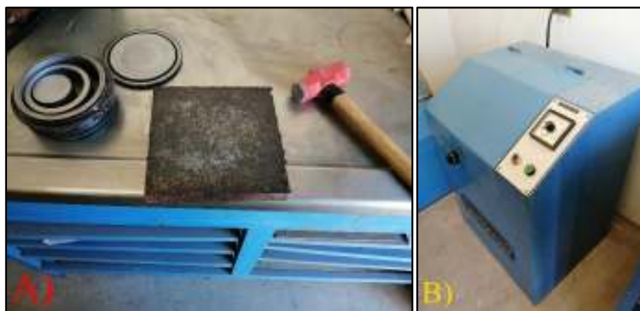
Figura 3. A) Equipo utilizado para la trituración de muestras por métodos manuales. B) Pulverizadora de anillos Marca HERZOG utilizada para la pulverización.
