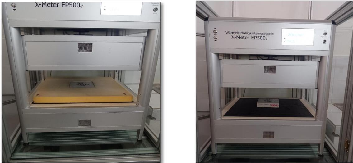
**Figura 4.2.3 Colocación de la muestra, la placa aislante de 5 mm y el material aislante en el centro del equipo de medición. (Elaboración Propia)**
