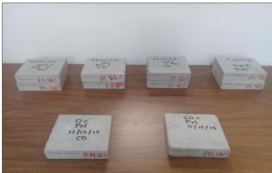
Figura 4.2.1. Muestras de Mortero cemento arena 1:4 con sustitución de perlita mineral al 0, 20, 40, 60, 80 y 100%. (Elaboración propia)
