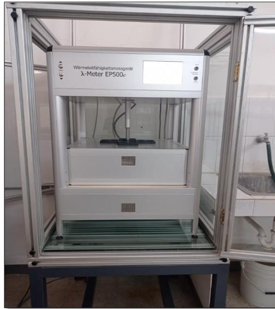
**Figura 4.2.2. Lamda meter EP 500- Equipo de medición de la conductividad térmica del material. (Elaboración propia)**
