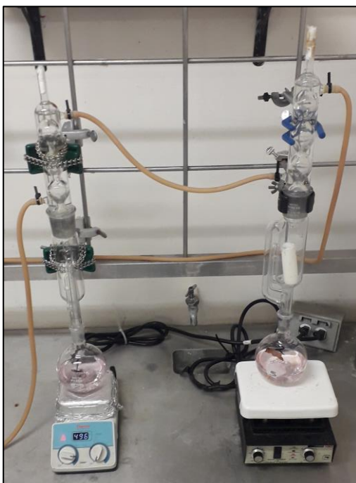
Figura 31. Equipo para extracción Soxhlet.
