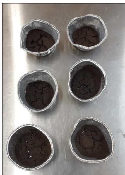
Figura 26. Muestras del tratamiento biológico para secado en horno.
