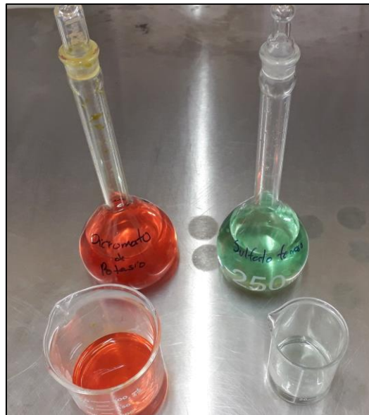
Figura 29. Reactivos para determinación del contenido de materia orgánica del suelo.
