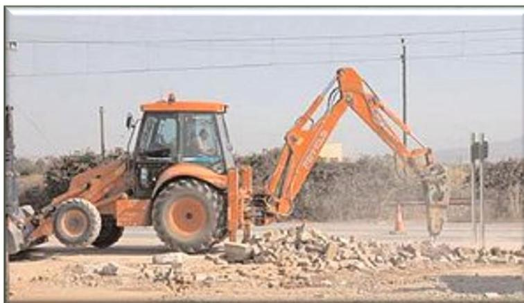
**Figura 3.6: Uso de maquinaria como esta retroexcavadora para fragmentación y extracción de rocas de cada tajo en la cantera de Las Minitas**
