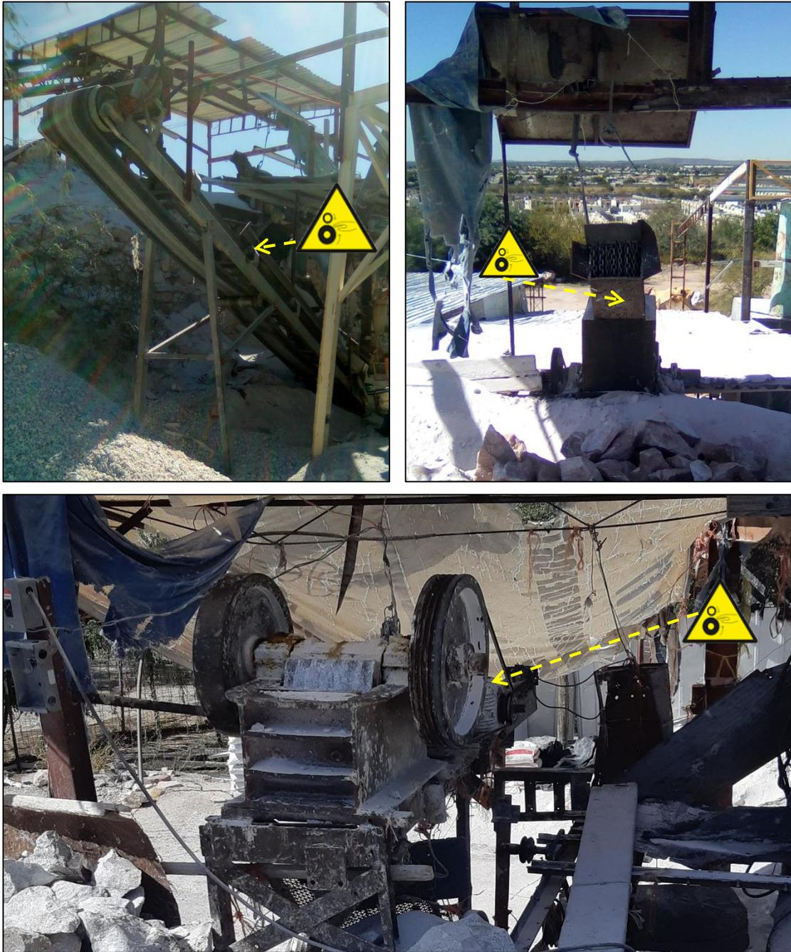
**Figura 4.6: Imágenes de análisis de riesgos mecánicos (RA) que pueden presentar los trabajadores por atrapamiento al utilizar la maquinaria**
