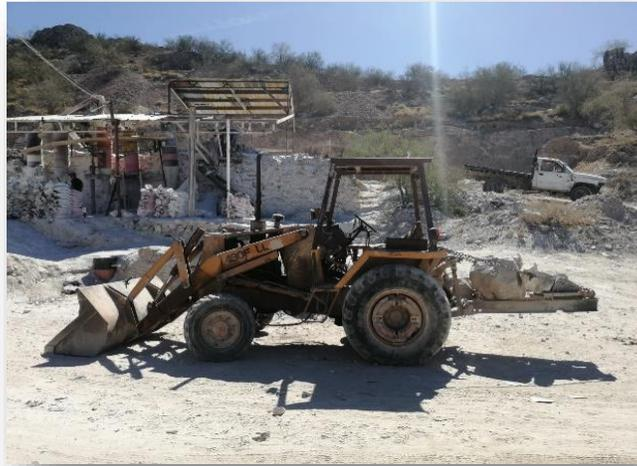
**Figura 3.11: Maquinaria utilizada para movimiento de grandes rocas que no pueden ser movidas en los vehículos de traslado de mineral dentro del área de la cantera**
