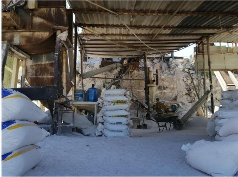
**Figura 3.10: Área de cribado y almacenamiento de las rocas en varios tamaños según el requerimiento del cliente**
