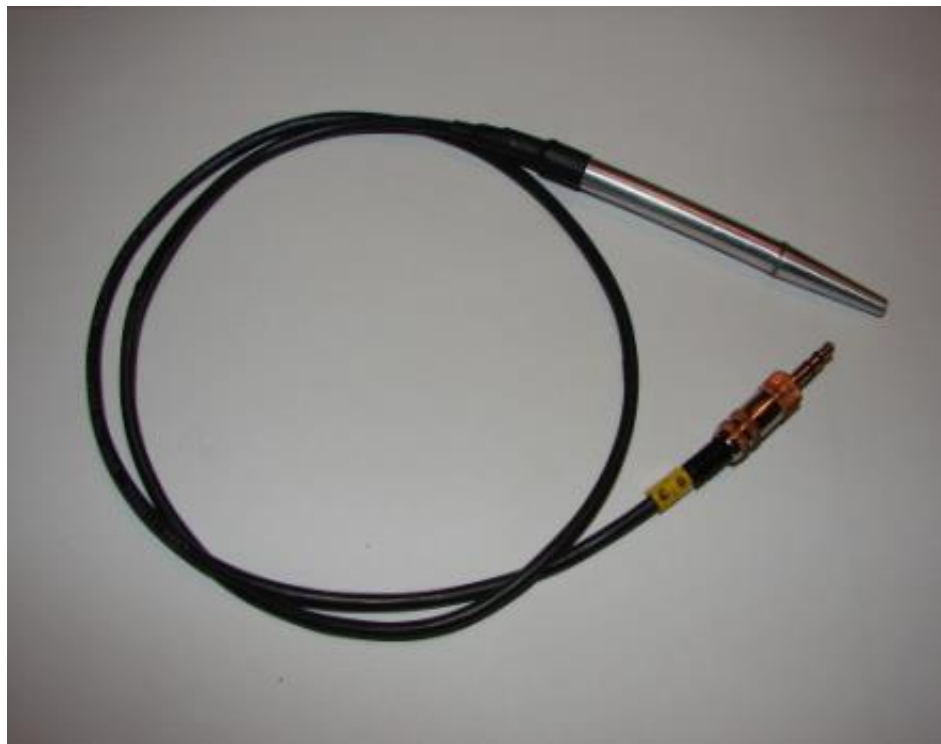
Figura 2.8. Sensor LM35 empacado, con conector Jack Estéreo (Tovar y Quiñones, 2008)
